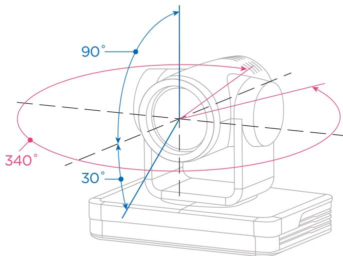
iCam® 4K PTZ 攝影機內建高階對焦算法確保鏡頭能夠快速、精確、穩定地自動對焦。水平轉動向左右各170°，合計340°大範圍，俯仰上下轉動向下30°、向上90°，水平控制速度最快高達每秒60°，俯仰控制速度最快高達每秒45°。
